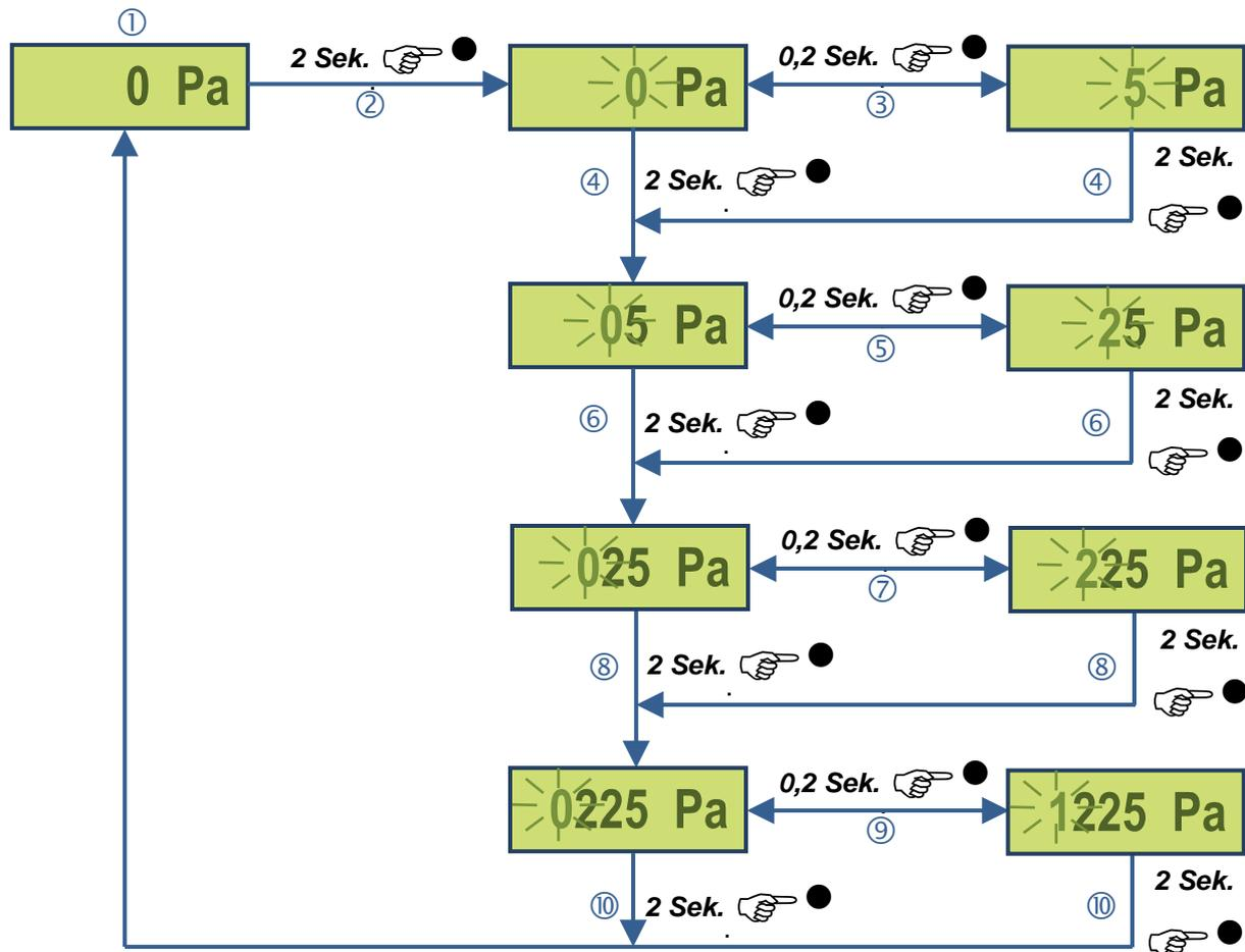
Die Filterüberwachung ist erst aktiviert, wenn ein Zahlenwert >0 eingegeben wird. Überschreitet der Druckwert den Schwellwert, blinkt der Druckwert in der Anzeige.
